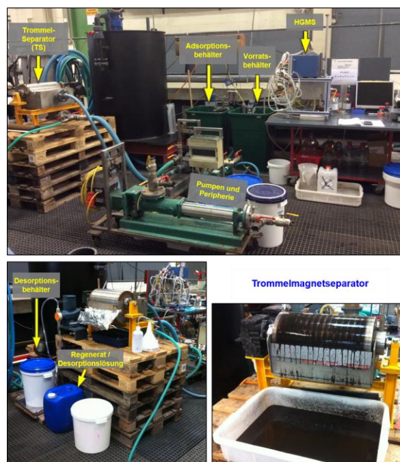
Abbildung 1: Versuchsaufbau zur Adsorption / Desorption von Phosphat aus Abwasser und Prozesswasser im Halbtechnikumsmaßstab am ISWA, Universität Stuttgart. (vgl. Drenkova-Tuhtan et al., 2017 ). 3
